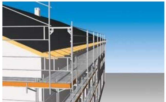
13 Lösung mit Innenkonsole am Gerüst. Sie verhindert, dass Personen zwischen Gerüst und Mauerwerk abstürzen.
