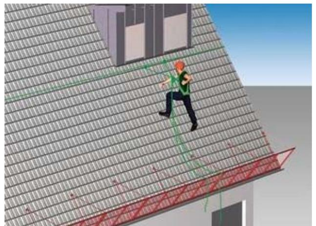
14 Arbeit am hängenden Seil. Als Zusatzmassnahme wurde eine Dachfangwand montiert, um herunterfallendes Material aufzufangen.
