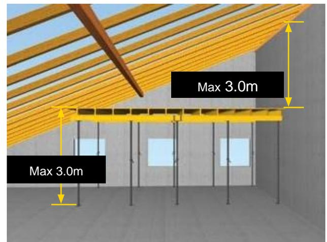
11 Fanggerüst unter einer Tragkonstruktion
