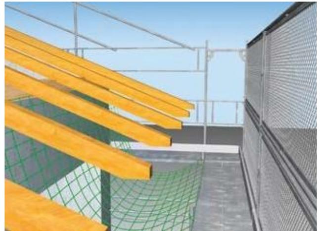
12 Lösung mit Auffangnetz im Dachvorsprung
