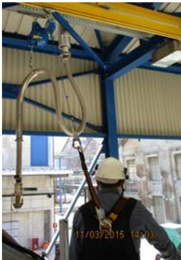
Abb. 11: Auffanggurt mit Höhensicherungsgerät
